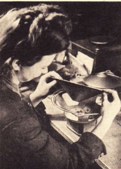
Kontrolle des Schlagens des Membranrandes mit Hilfe eines Plattenspieler
