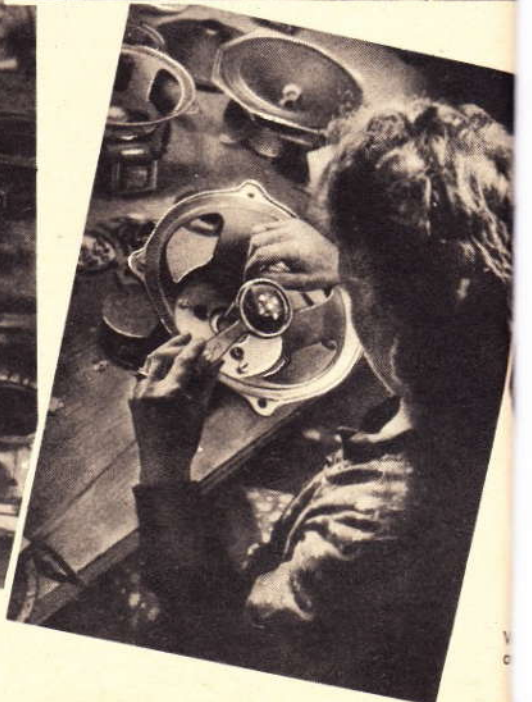
Einsetzen der Membran beim Freischwinger (links). Anschließend erfolgt die Verlötlung des Membranhütchens mit dem Steckstift
