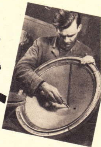
Einschrauben einer großen geklebten Membran
